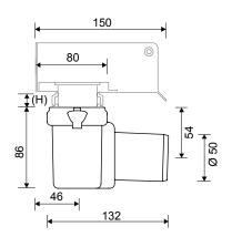
Unidad de desagüe horizontal de Ø50mm, con barrera antiolor extraíble y accesible para la limpieza.
