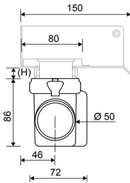
Unidad de desagüe horizontal de  $\varnothing 50\text{mm}$ , con barrera anti-olor extraíble y accesible para la limpieza.
