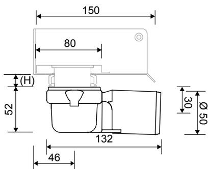
Unidad de desagüe horizontal de Ø50mm, con barrera anti-olor extraíble y accesible para la limpieza.
