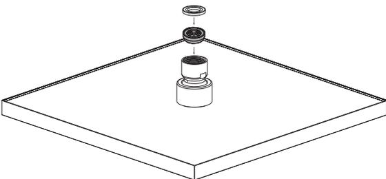
El reductor va ubicado en el interior del cabezal.
